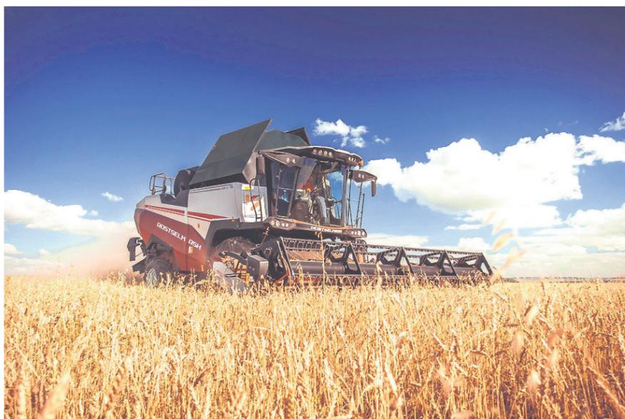
тур без учета пропашных. На ACROS 595 Plus устанавливается двигатель Cummins/6LTAА мощностью 325 л. с. и топливный бак емкостью 540 л. За счет экономичности мотора и усовершенствованной конструкции машина расходует горючего не более, чем ACROS 585.
